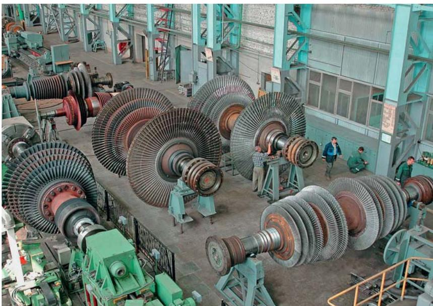
↻ В цехе ремонта роторов паровых турбин
