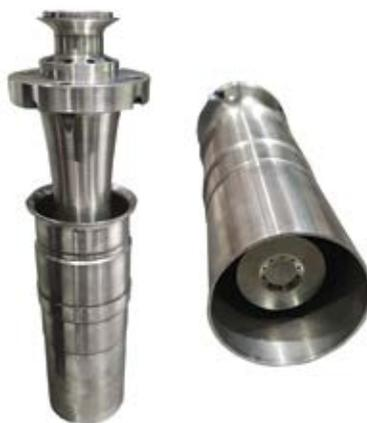
Рисунок 6.44. Сертификационная форсунка камеры сгорания
