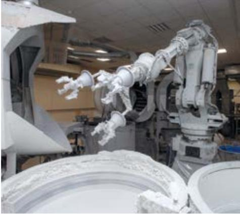
Рисунок 6.22. Робот-манипулятор и ванны с суспензией и обсыпкой
