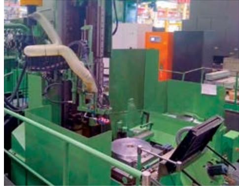
Рисунок 6.8. Протяжной станок фирмы Hoffmann
