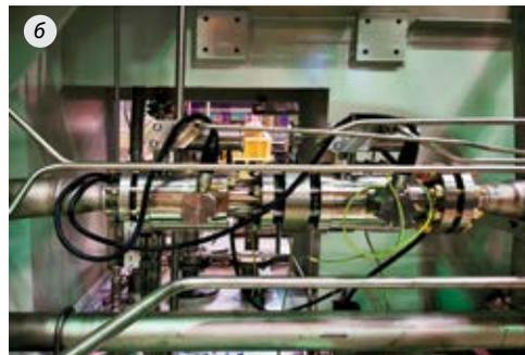
Рисунок 6.56. Клапан стопорный: а) иностранного производства; б) отечественного производства
