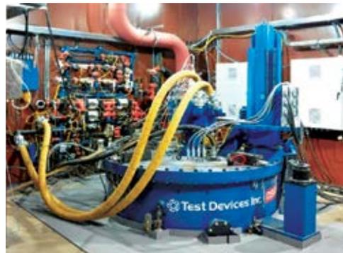
Рисунок 6.14. Стенд для проведения автофреттирования с модернизацией ЦИАМ
