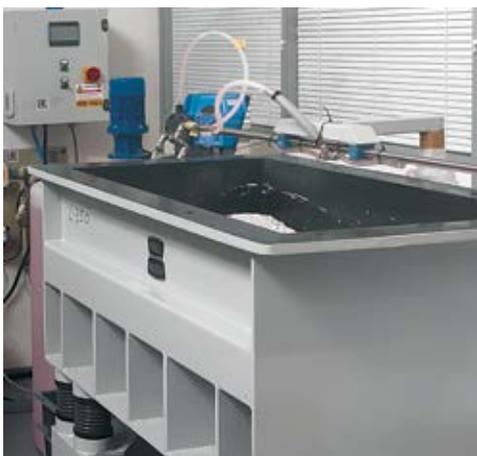
Рисунок 6.4. Виброгалтовочное оборудование фирмы Rollwasch
