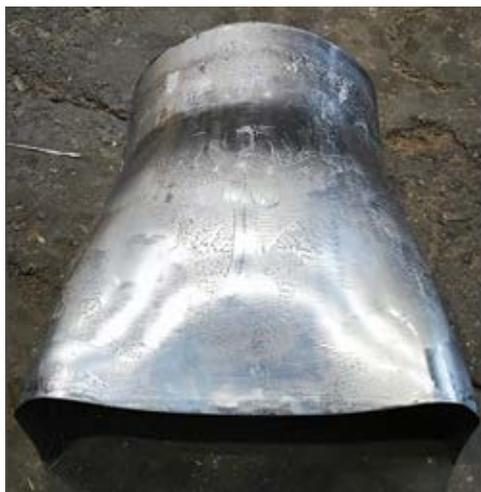
Рисунок 6.43. Пробная штамповка переходной секции
