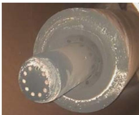
Рисунок 5.4. Обломленный картридж форсунки (ТО-24000)
