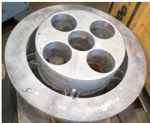
Рисунок 6.41. Эффузионная пластина крышки 4+1
