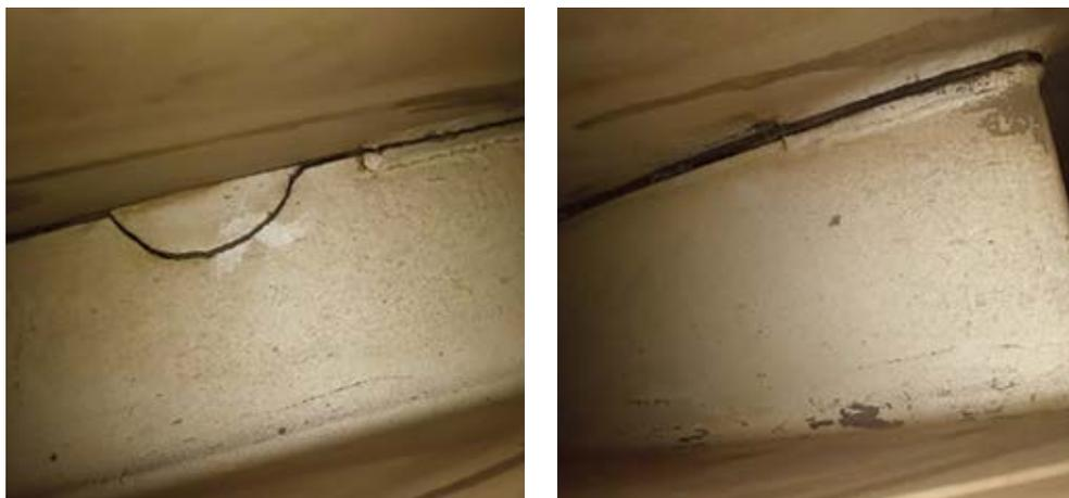
*Рисунок 5.66. Трещина на лопатке диффузора 1-й ступени*
