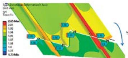
Рисунок 6.26. Натяг на стыке бандажных полок
