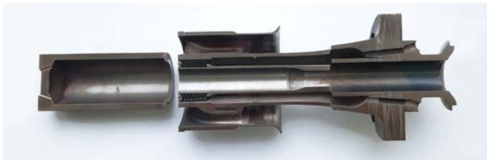
Рисунок 6.45. Разрез форсунки камеры сгорания
