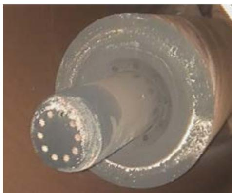
Рисунок 5.4. Обломленный картридж форсунки (ТО-24000)
