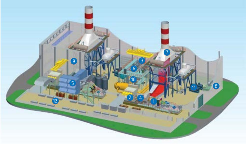
Рисунок 8.11. Размещение оборудования ПГУ-84: 1 – газотурбинный двигатель типа Т32; 2- турбогенератор ГТУ; 3 – турбогенератор ПГУ; 4 – редуктор; 5 – воздухоочистительное устройство; 6 – паровая турбина; 7 – паровой котел утилизатор; 8 – система воздушного отопления и обогрева; 9 – АСУ ТП; 10 – сетевой подогреватель; 11 – сетевые насосы; 12 – электротехническое отделение
