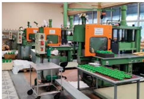
Рисунок 6.18. Шприц-машины
