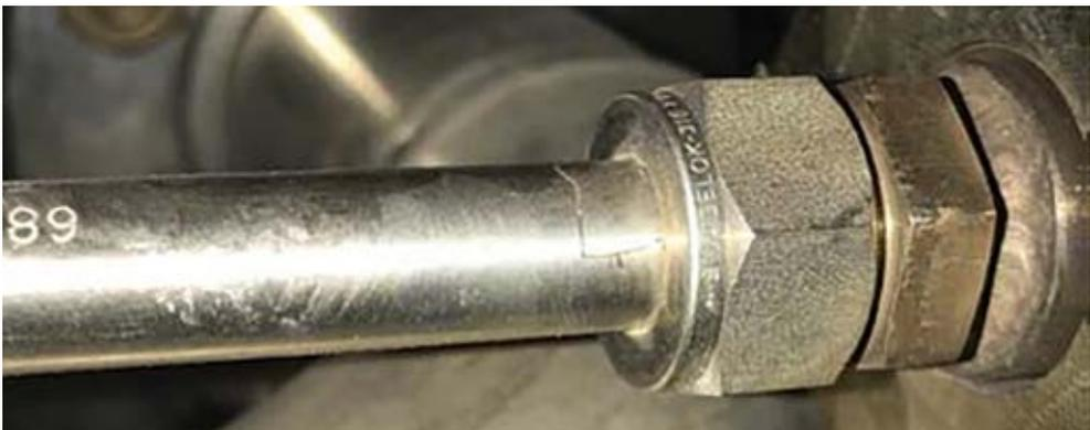
Рисунок 5.14. Трещина в районе закрепления воспламенителя в свече зажигания
