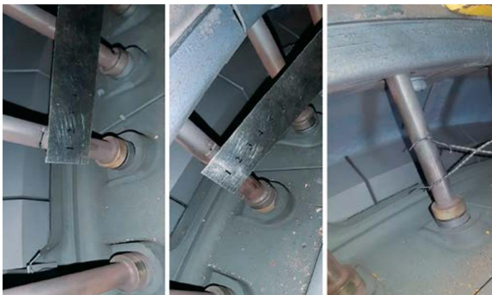
Рисунок 5.43. Повреждения («пропилы») трубок охлаждающего воздуха
