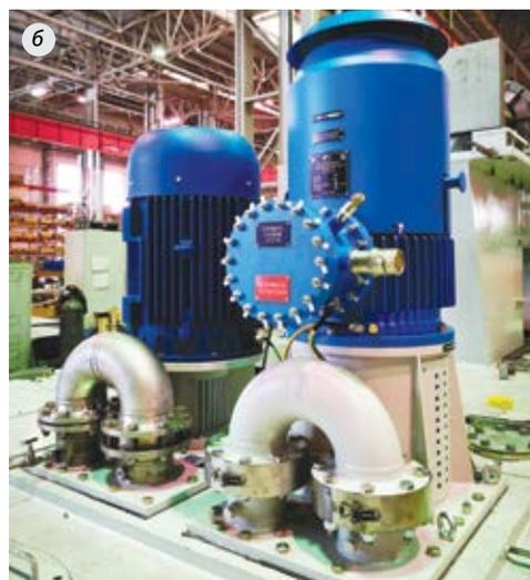
Рисунок 6.54. Аварийный и вспомогательный масляные насосы: а) иностранного производства;
