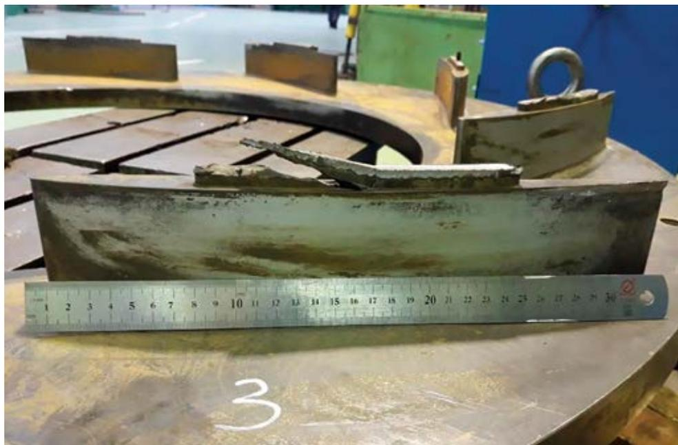
*Рисунок 5.67. Трещина на лопатке диффузора 2-й ступени*
