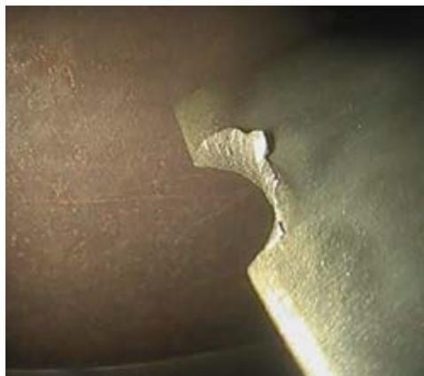
Рисунок 5.49. Повреждение рабочей лопатки ОК
