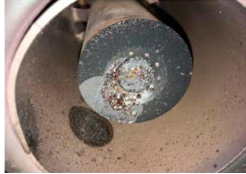
Рисунок 5.5. Загрязнение форсунки картриджного типа (наработка форсунок 8863 часа)
