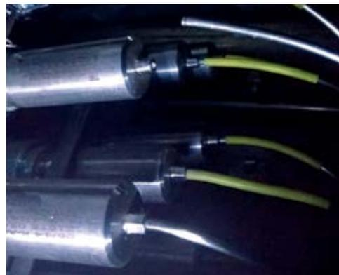
Рисунок 5.46. Обрыв термопары на выхлопе агрегата
