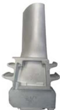
Рисунок 6.37. Отливка рабочей лопатки
