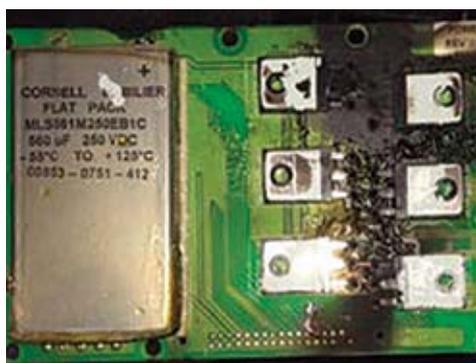
Рисунок 5.52. Выгорание на плате блока управления
