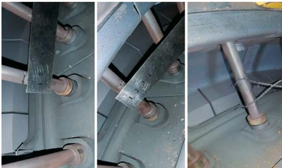
Рисунок 5.43. Повреждения («пропилы») трубок охлаждающего воздуха
