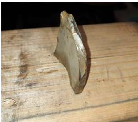
Рисунок 5.71. Посторонний предмет в рабочем колесе ЦБК
