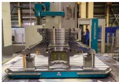
Рисунок 6.6. Горизонтально-расточной станок фирмы РАМА
