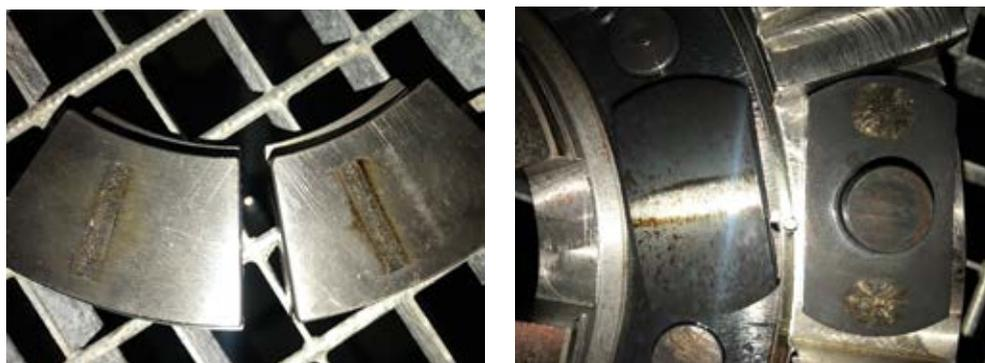
Рисунок 5.64. Износ элементов упорного подшипника
