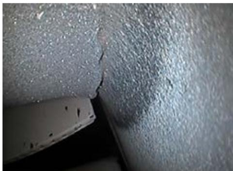
Рисунок 5.25. Эрозионный износ входной кромки соплового аппарата второй ступени ТВД (наработка 4032 часа)
