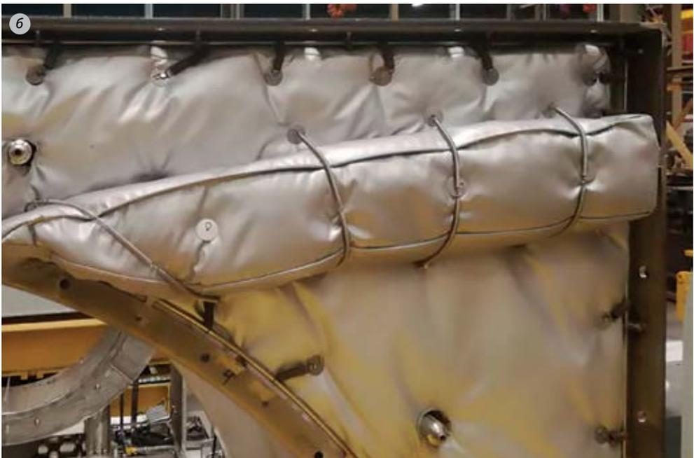
Рисунок 5.47. Места установки дополнительной изоляции выхлопного патрубка:
