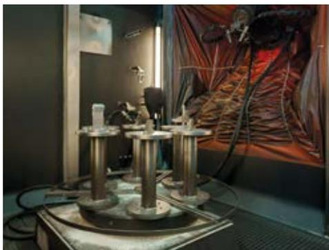
Рисунок 6.2. Роботизированная установка дробеструйного упрочнения фирмы Rosler
