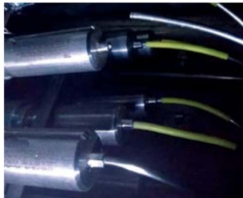
Рисунок 5.46. Обрыв термопары на выхлопе агрегата
