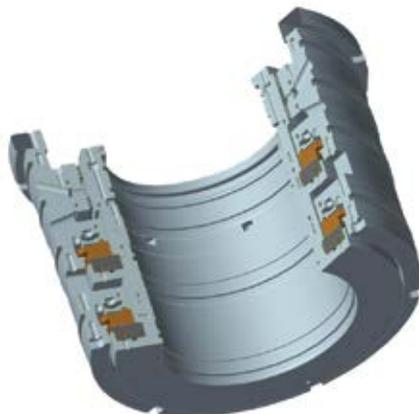
Рисунок 3.9. Модель сухих газодинамических уплотнений
