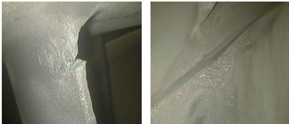
Рисунок 5.23. Эрозионный износ и прогар с трещиной выходной кромки аппарата первой ступени ТВД (ТО-8000)
