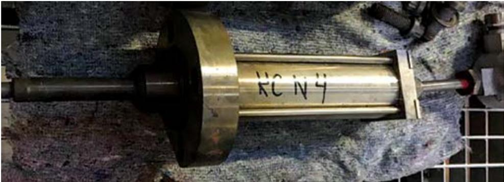
Рисунок 5.13. Разрушение наконечника воспламенителя старого типа (красная метка)
