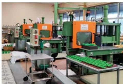
Рисунок 6.18. Шприц-машины
