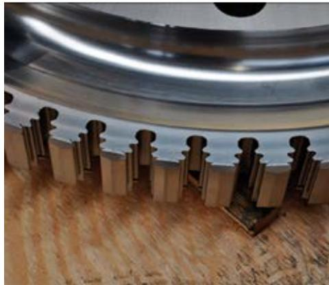
Рисунок 6.10. Диск турбины ТНД
