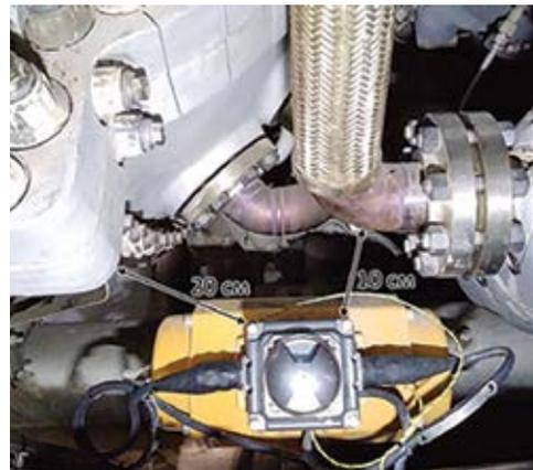
Рисунок 5.50. Расстояние от АПК до горячих поверхностей
