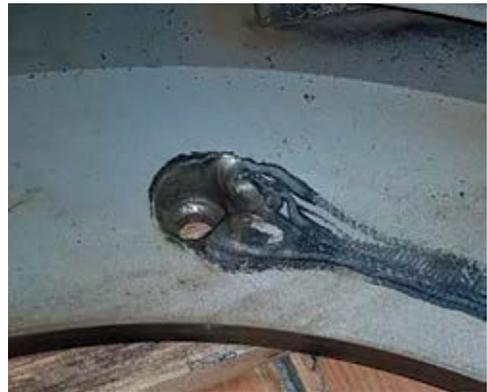
Рисунок 5.69. Места обрыва крепежа диффузора 2-й ступени
