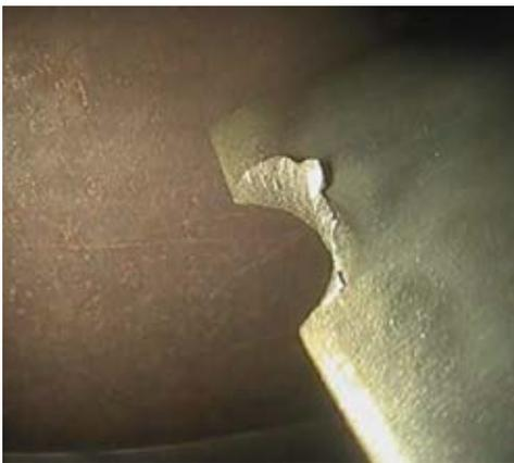
Рисунок 5.49. Повреждение рабочей лопатки ОК
