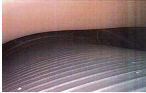
Рисунок 5.18. Деформация экрана жаровой трубы
