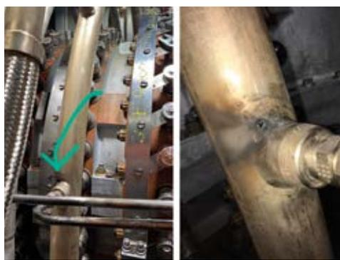
Рисунок 5.55. Прогары импульсных трубок при коротком замыкании
