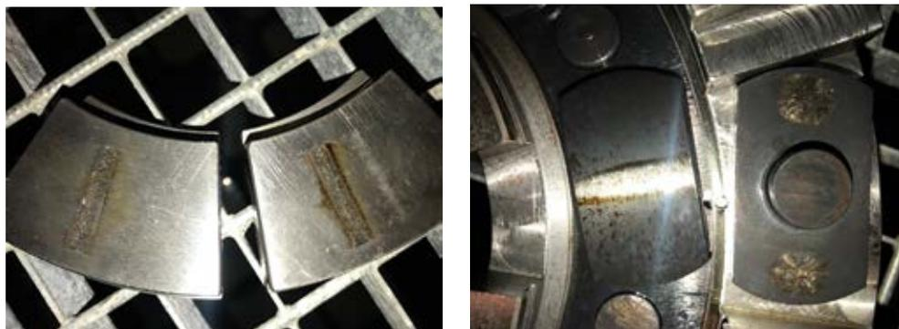
Рисунок 5.64. Износ элементов упорного подшипника
