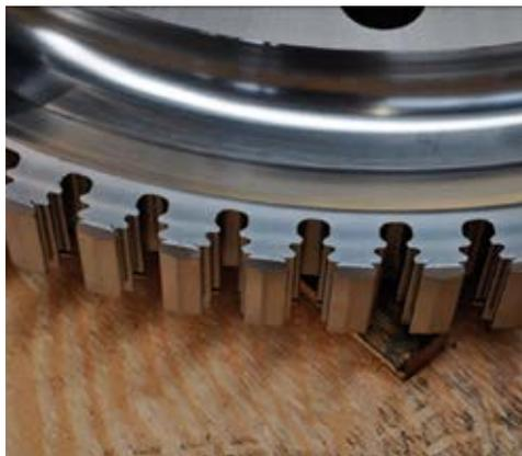
Рисунок 6.10. Диск турбины ТНД
