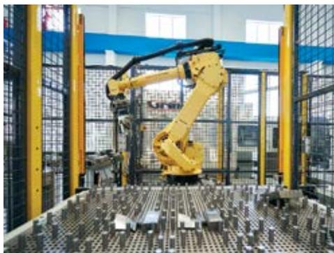
Рисунок 6.3. Роботизированный комплекс с 5-координатными фрезерными обрабатывающими центрами UNIKA 1100 и UNIKA 1700
