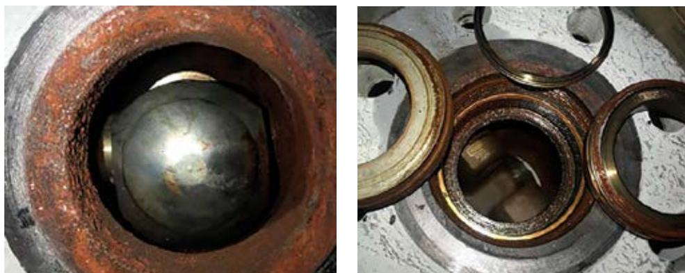
Рисунок 5.53. Отложения на элементах продувочного клапана
