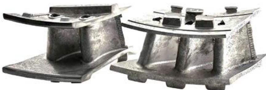
Рисунок 6.36. Отливки сопловых аппаратов 1-2-ой ступени ТВД
