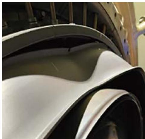
Рисунок 5.35. Деформация наружной секции переходного патрубка ТНД (наработка 28 888 часов)
