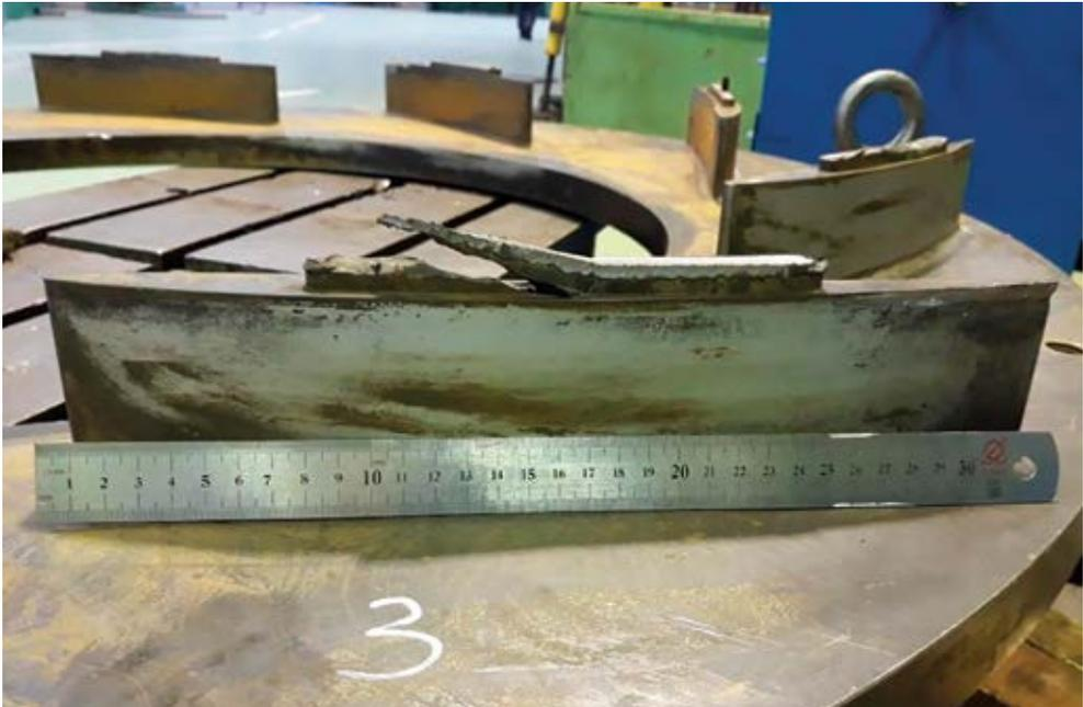
Рисунок 5.67. Трещина на лопатке диффузора 2-й ступени
