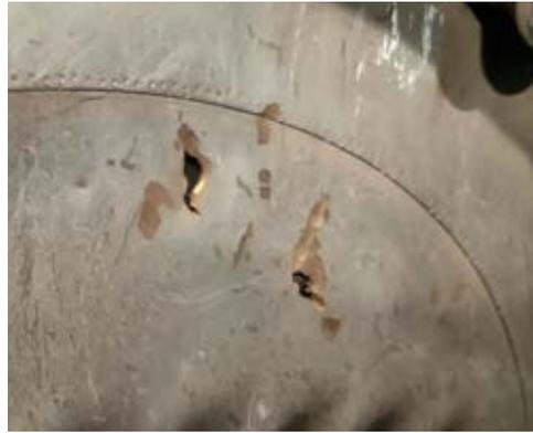
Рисунок 5.41. Пробоины в верхней части переднего эллиптического экрана
