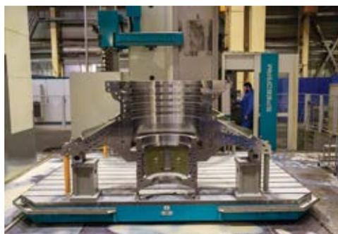
Рисунок 6.6. Горизонтально-расточной станок фирмы РАМА
