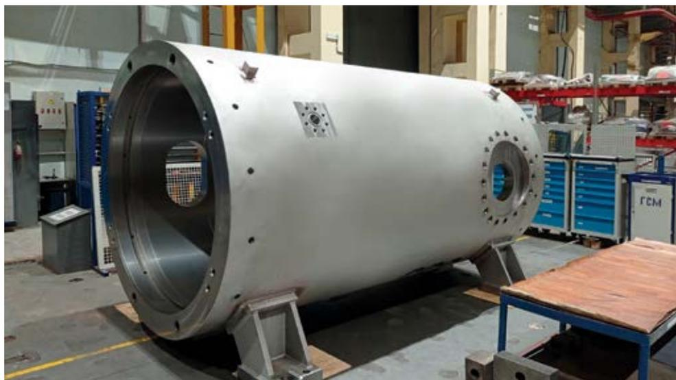
Рисунок 3.3. Корпус компрессора в производстве
