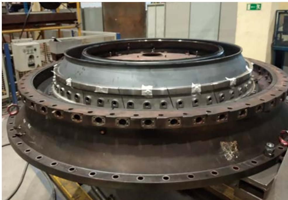
Рисунок 6.28. Контрольная сборка локализованного модуля ТНД
