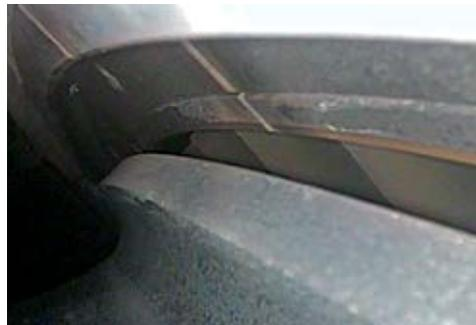
Рисунок 5.39. Смещение наружного переходного патрубка вниз (наработка 17 503 часа)
