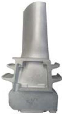
Рисунок 6.37. Отливка рабочей лопатки
