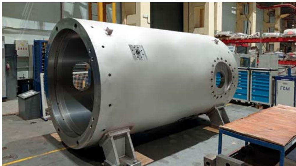
Рисунок 3.3. Корпус компрессора в производстве
