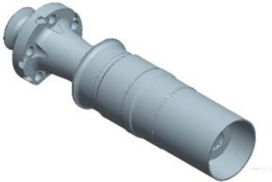
Рисунок 2.16. 3D-модель топливной форсунки
