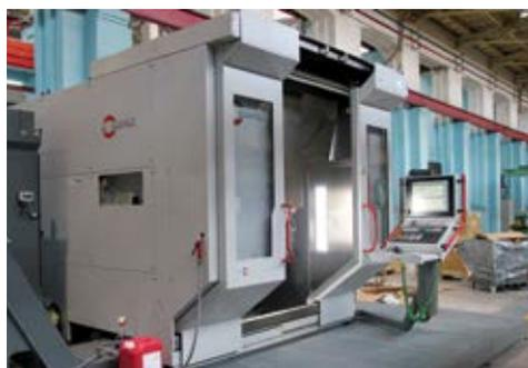
Рисунок 6.7. Фрезерный станок с токарной функцией фирмы Hermle
