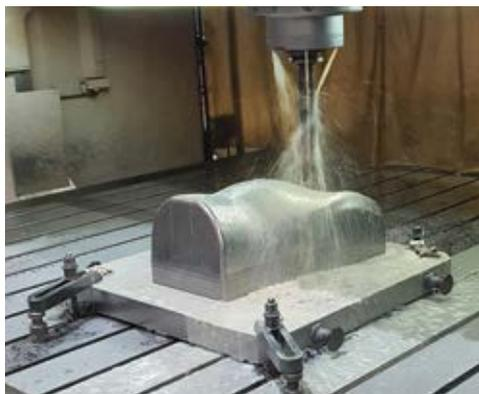
Рисунок 6.42. Изготовление штамповой оснастки для деталей переходной секции
