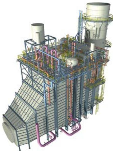
Рисунок 8.13. Вертикальный двухконтурный котел-утилизатор АО «Красный котельщик»
