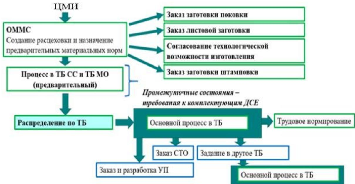
Рисунок 12.6 – Схема автоматического процесса распределения заданий на разработку в зависимости от вида работ и цеха-исполнителя
