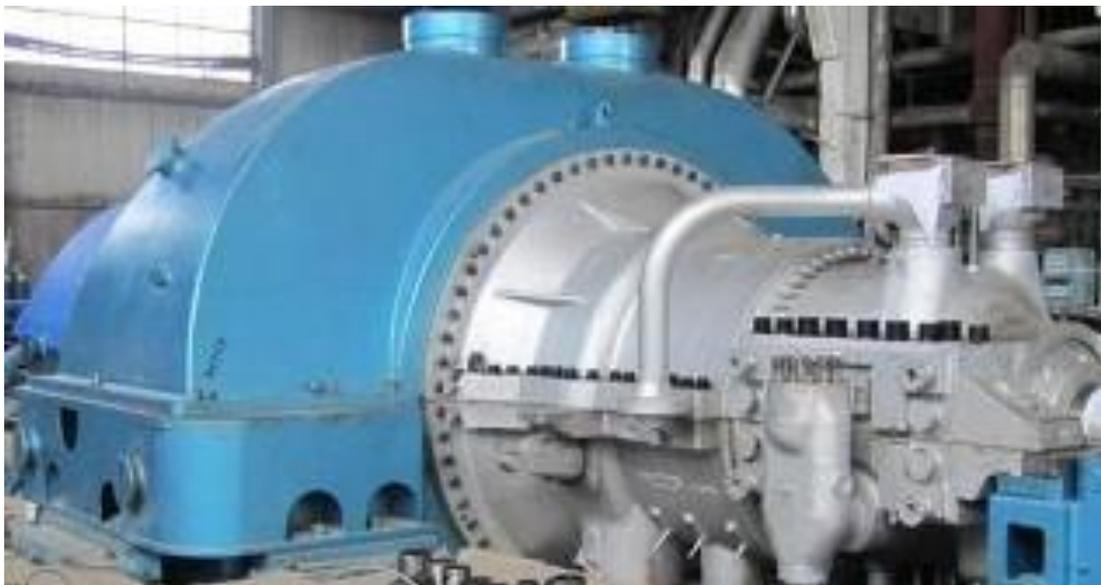
Рисунок 5.11 – Фото паровой турбины типа П-25-3,4/0,6 производства КТЗ
