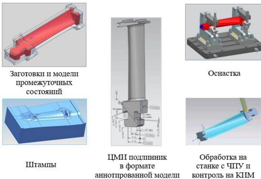
Рисунок 12.7 – 3Д-модели промежуточных состояний производства рабочей лопатки паровой турбины: настроены ассоциативные связи между основной моделью и вспомогательными моделями оснастки и приспособлений
