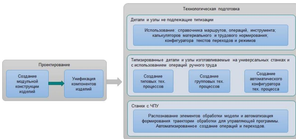
Рисунок 12.8 – Блок-схема ТПП энергомашиностроительного оборудования при создании модульных конструкций
