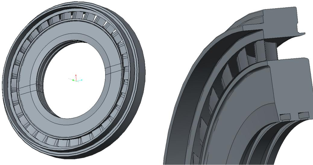
Рисунок 3.8 – Диафрагма 5-й ступени ЦВД турбины типа Т-295/335-23,5
