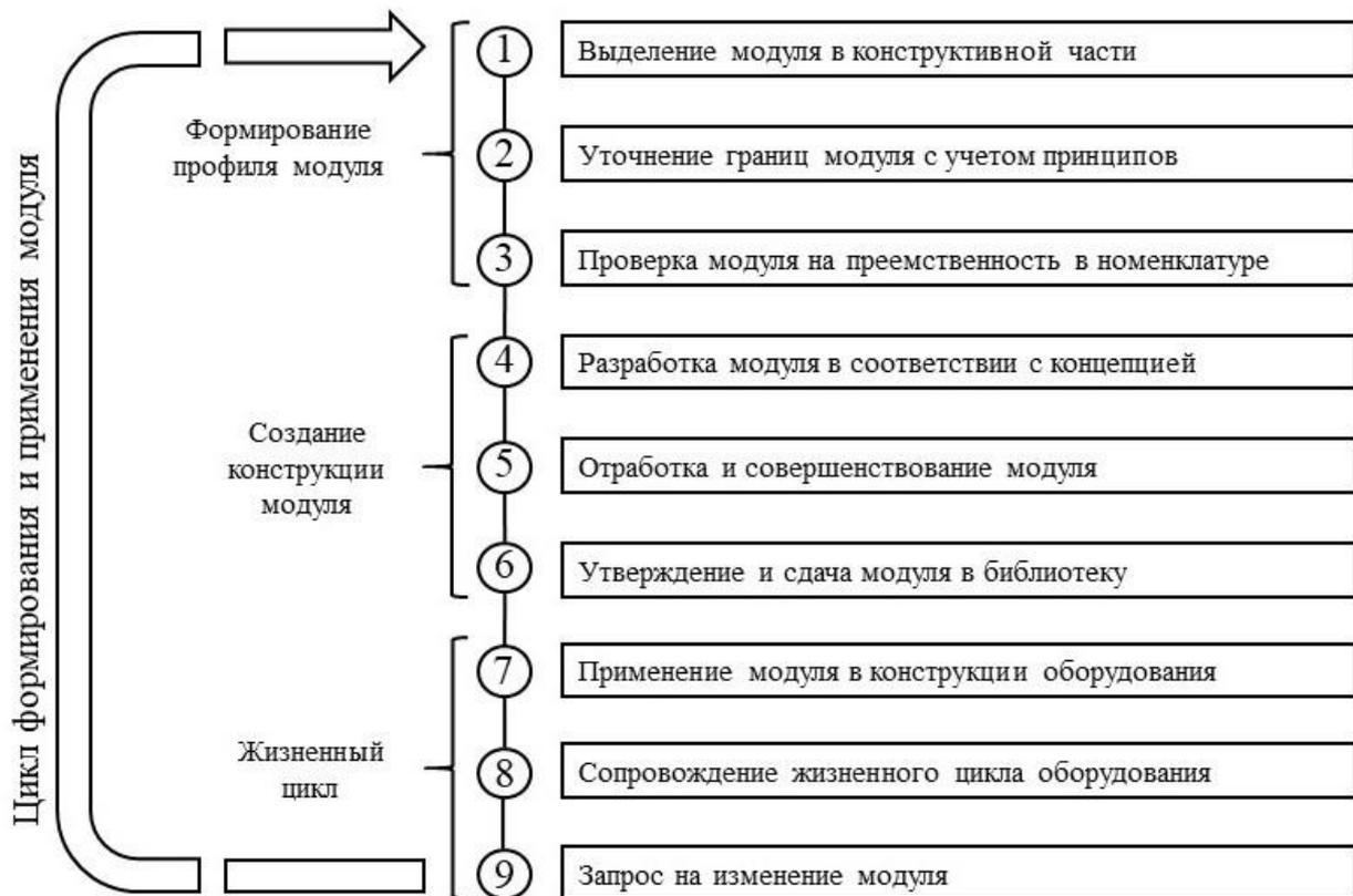
Рисунок 7.7 – Алгоритм работы с модулем
