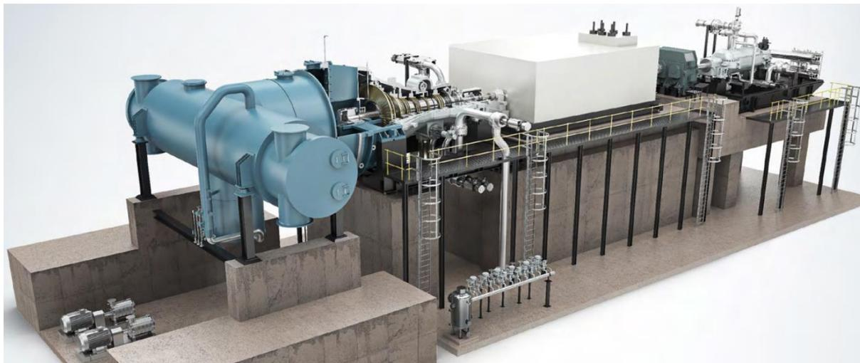
Рисунок 18.11 – 3Д-модель модульной ПСУ с «улучшенной платформой»: используется две паровые турбины модульной конструкции серий SST-700 и SST-900 компании Siemens
