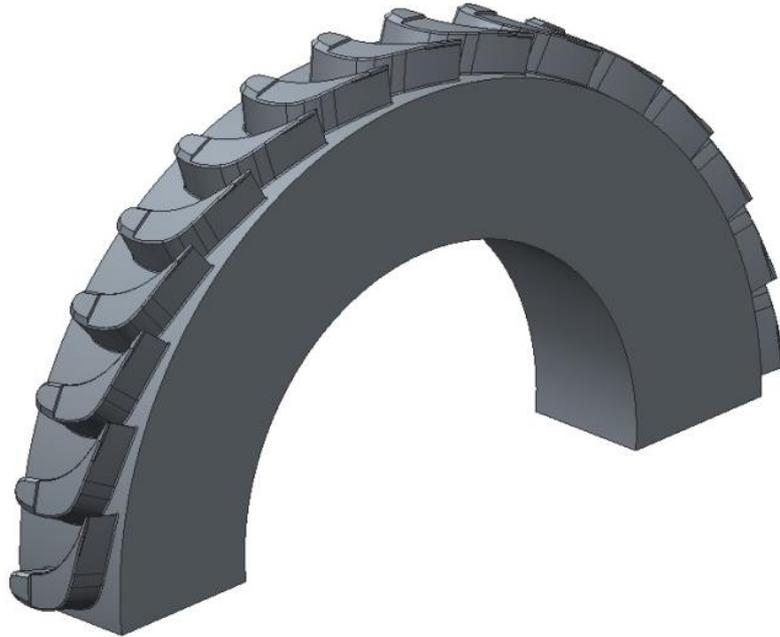
Рисунок. 3.7 – Направляющие лопатки комбинированного типа моноблоком с телом половины диафрагмы «венцового» типа
