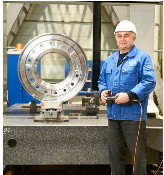
Проведение измерений на координатно-измерительной машине
