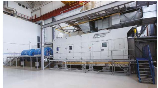
Испытательный стенд газовой турбины T16
