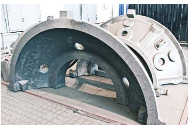
Элементы корпуса турбины
