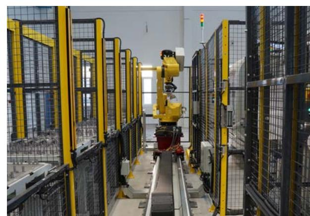
Роботизированный станок Fanuc M-710 iC 70
