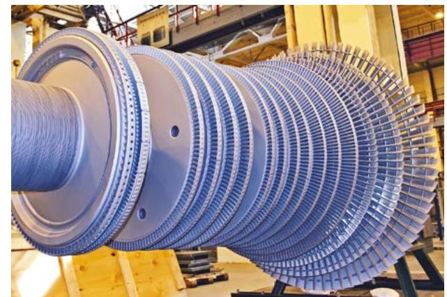
Ротор турбины K-22-90-2М
