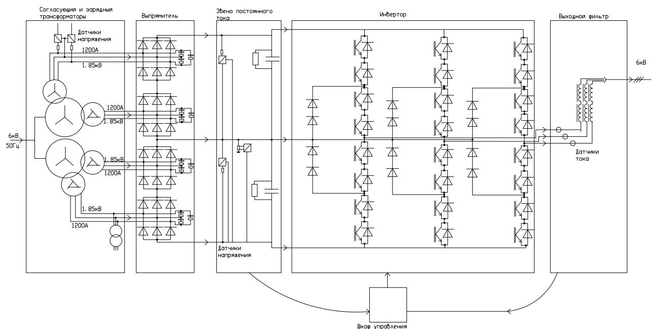
Структурная схема электрической части ПЧТ 6-10000-6-Ж-01
