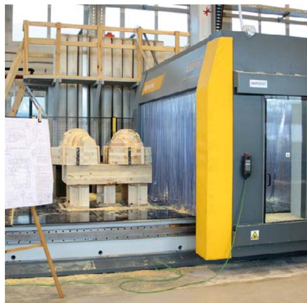
Пятикоординатный станок Dinamic FC 4000 сnc для изготовления моделей
