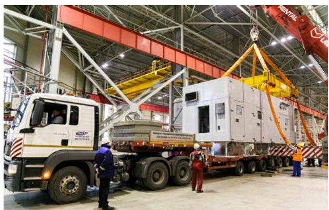
Транспортировка ГТУ T16 в состоянии полной заводской готовности
