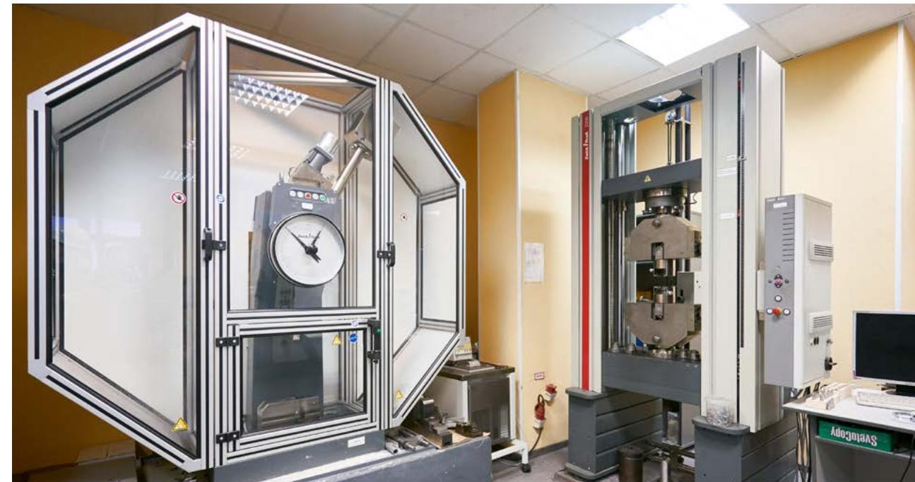
Копер RKP450 и испытательная машина Z250
