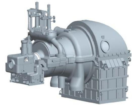
3D-модель паровой турбины двух давлений K-25-6.0 на базе турбины Т-30-90 с конденсатором
