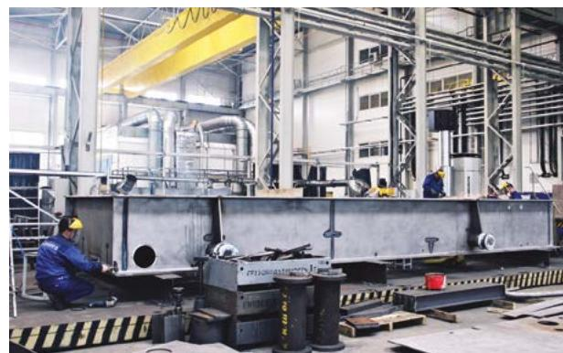
Изготовление рамы вспомогательных устройств
