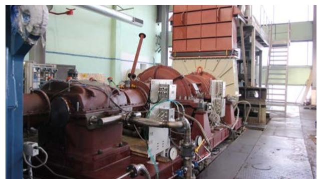
Испытательный стенд осевых компрессоров
