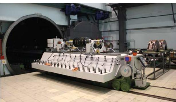
Разгонно-балансировочный стенд фирмы Schenck
