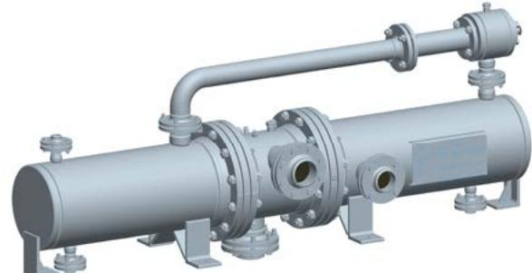
3D-модель отсасывающей установки
