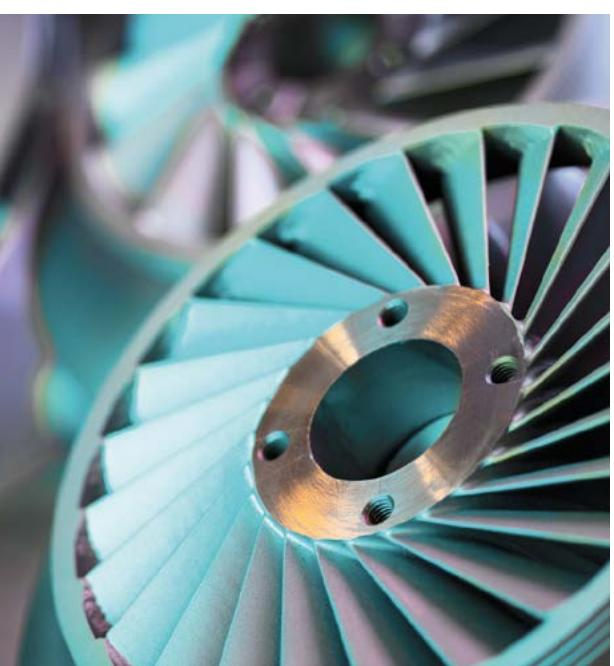
Согласно Программе унификации ГПА (ПАО «Газпром»), Невским заводом был разработан и изготовлен унифицированный центробежный компрессор мощностью 16 МВт и с политропным КПД на уровне 87–88 %. Унификация центробежных компрессоров заключается в разработке универсальных элементов проточной части, узлов уплотнений и подшипников. Преимущество унифицированных центробежных компрессоров состоит в уменьшении сроков изготовления и затрат на производство.
