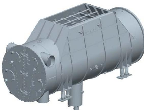
3D-модель конденсатора КП-1300-V
