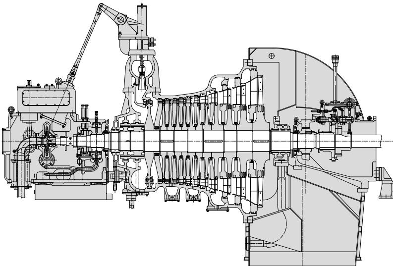
Продольный разрез паровой турбины К-19-35
