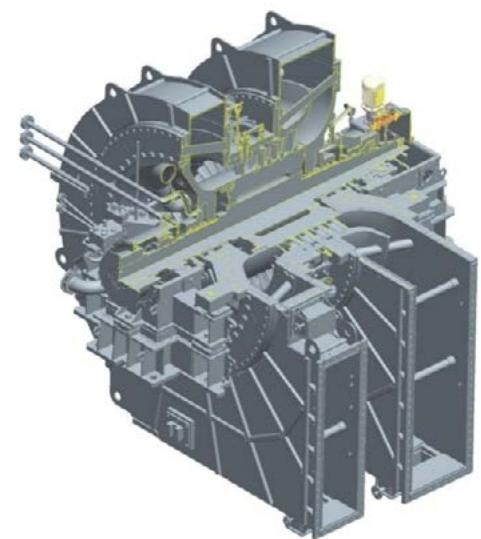
Детандер-генераторные агрегаты (ДГА) для выработки электроэнергии за счет использования давления природного газа
