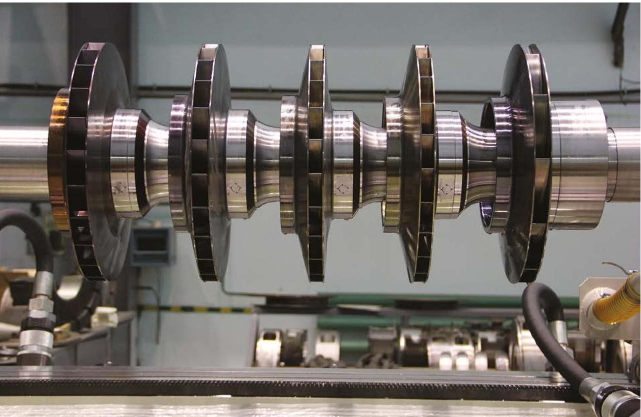
Ротор 155 СПЧ на разгонно-балансировочном станке Schenck
