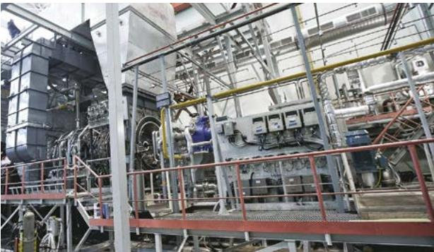
Испытательный стенд газовых турбин мощностью 32 МВт
