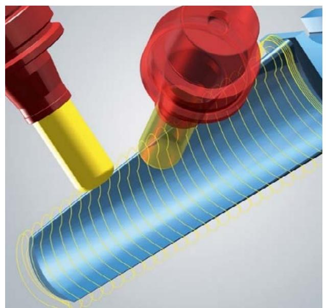
Симуляция фрезерной 5-осевой обработки направляющей лопатки осевого компрессора
