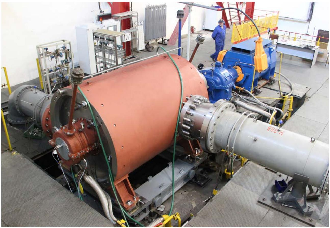
Испытательный стенд центробежных компрессоров
