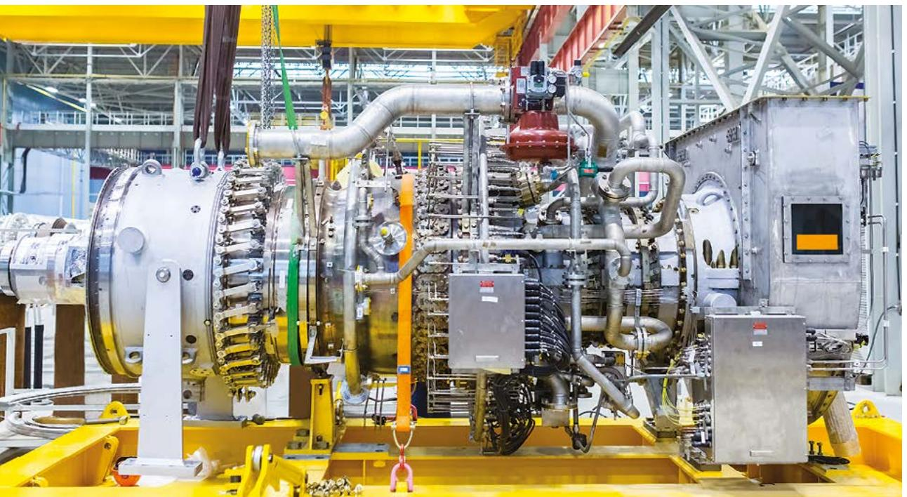
Газотурбинная установка Т16
