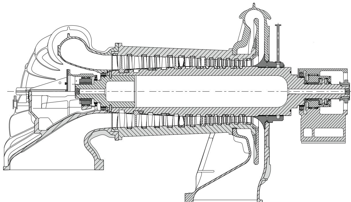
Продольный разрез осевого компрессора K-3750/3,3
