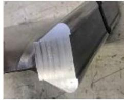
Рабочая и направляющая лопатки компрессора окончательно готовые
