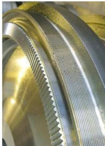
Диски компрессора и турбины ГТЭ-170 после механической обработки и шлифовки хиртов
