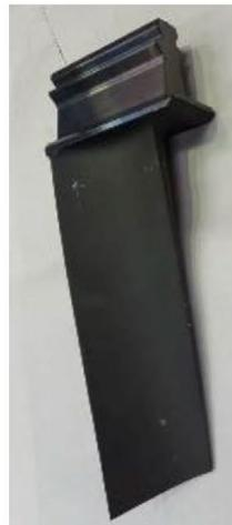
Рабочая лопатка 2 ступени турбины в электроэрозионном сверлильном станке. Рабочая лопатка 2 ступени после мехобработки замка и термоциклирования
